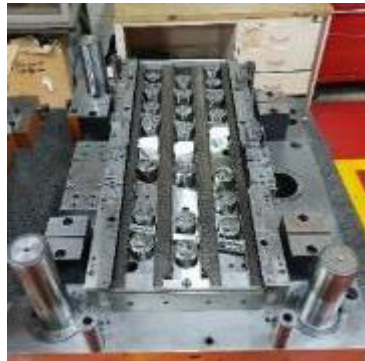
Conversion Tooling Main Die + Tab Die (SLAC Die-Set)
